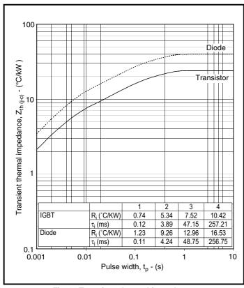
Fig. 11 Transient thermal impedance
